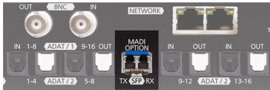
Bei höheren Frequenzen reicht die Bandbreite von MADI nicht mehr für die volle Kanalzahl aus. Daher werden mehrere Kanäle gebündelt (SMUX Betrieb), um eine hohe Datenrate übertragen zu können. Als Folge verringert sich die Anzahl der übertragbaren Kanäle wie folgt:
