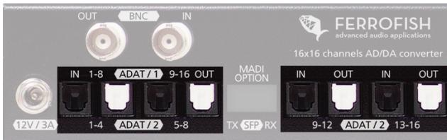
Jede ADAT Schnittstelle kann bei SMUX/1 acht Kanäle übertragen. Bei SMUX/2 verringert sich die Anzahl der Kanäle auf vier. Da die PULSE16 DX vier Schnittstellenpaare besitzt, können also auch bei SMUX/2 noch alle analogen 16 Ein- und 16 Ausgangskanäle mit ADAT übertragen werden.
