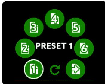
Nach der Auswahl der Nummer des zu ladenden Presets lassen sich im nächsten Bildschirm festlegen, welche Einstellungen geladen werden sollen: GAINS der analogen Eingänge, LEVELS der analogen Ausgänge sowie das ROUTING. Alle drei Punkte können individuell an- oder abgewählt werden.
