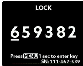
Nach Eingabe der korrekten PIN halten Sie die MENÜ Taste bitte eine Sekunde lang gedrückt. Das Gerät ist danach gesperrt.
