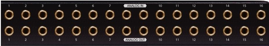
Alle analogen Ein- und Ausgänge sind auf 6.3mm Klinkenbuchsen symmetrisch ausgeführt und können auf Pegel bzw. Empfindlichkeiten zwischen -8dBu und +20dBu eingestellt werden. Jeder Kanal (Eingang und Ausgang) kann dabei einzeln eingestellt werden, alle Werte werden digital berechnet.
