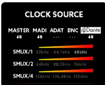
In den Feldern unterhalb der Quelle ist die gemessene anliegende Samplefrequenz zu sehen. Im Feld „Master“ wird die aktuelle Frequenz des internen Wordclock-Generators der PULSE16 DX angezeigt. Liegt keine lesbare Frequenz an, erscheint „- - -“ unterhalb des Feldes.
