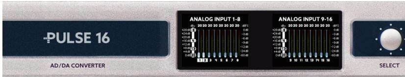
Die über dem Fader angegebene Zahl gibt den Pegel an, welchen der Wandler maximal verarbeiten kann. Ist der Fader bei Kanal 1, wie im Bild oben, auf einen Wert von 20 eingestellt, kann der Eingang einen Pegel von maximal  $+20\text{dBu}$  verarbeiten und würde in diesem Fall  $0\text{dBFS}$  auf der digitalen Seite ausgeben. Höhere Werte würden zu digitalem Clipping führen, was Sie vermeiden sollten.
