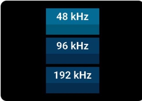
Entsprechend gelangen Sie bei den Einstellungen ADAT und BNC in die Ansicht der Abtastrate, die am entsprechenden Eingang erkannt wurde.
